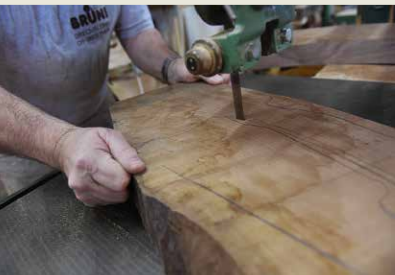
So entsteht eine Armbrust: Die grobe Form wird aus einem Stück Nussbaumholz zugeschnitten und weiter von Fredy Wiedmer (Bild 3) und Hans-Jürg Bruni (Bild 4) bearbeitet.
